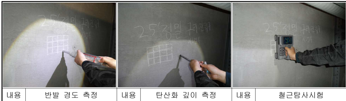
【사진 1.5】 구리인출 전력구 재료시험 전경
